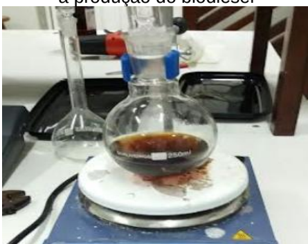
Figura 5 - Reação de transesterificação para a produção do biodiesel
